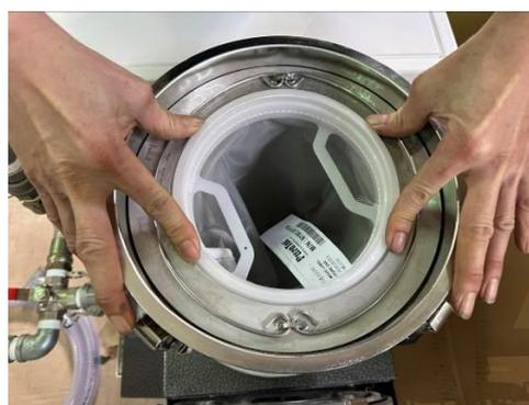
Вставьте фильтр в паз обеими руками, зафиксируйте уплотнитель до упора.
