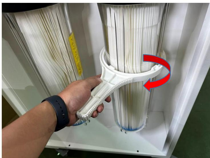
Снимите фильтр для очистки, а затем установите его на место
