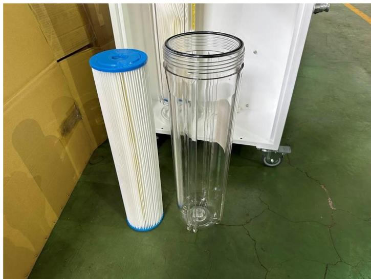
При замене фильтра придерживайте нижнюю часть корпуса фильтра левой рукой, а правой рукой поворачивайте корпус фильтра против часовой стрелки, чтобы затянуть его.
