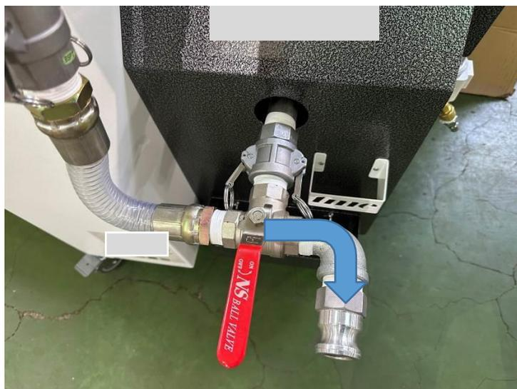
Поверните переключатель вправо, жидкость пройдет через фильтровальный мешок и два лепестковых фильтра и выйдет из левого отвода.
