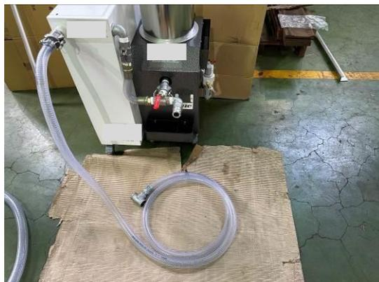
При использовании всех трёх фильтров необходимо установить дренажную трубу на втором отводе.
